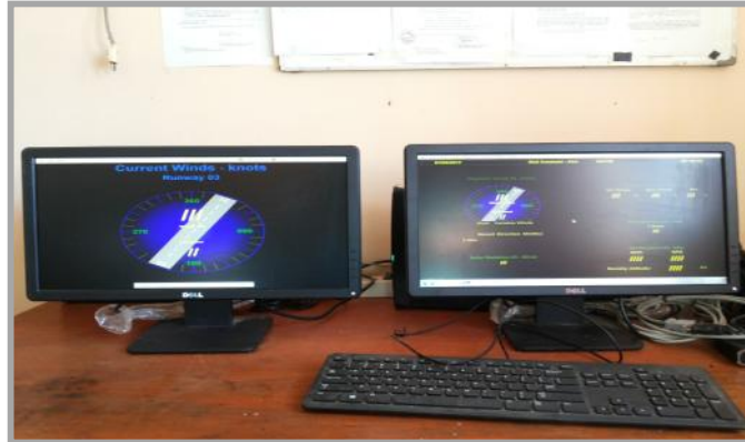
Gambar 12. Display Simple AWOS (SIMO) Stasiun Meteorologi Mali – Alor pasca kejadian Hujan Lebat dan Badai Petir Hebat Tgl. 02 Mei 2017 (Error DCP 13 – Communication Error)
